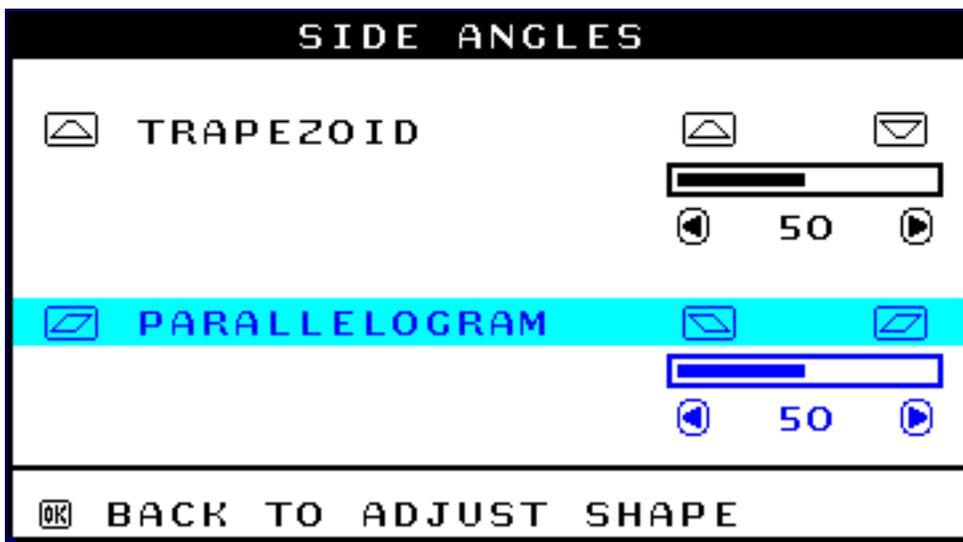
8) To adjust the parallelogram, press the or button.
